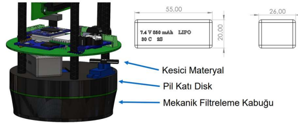
Şekil. 5 Ayrılma Sistemi Yapısı
